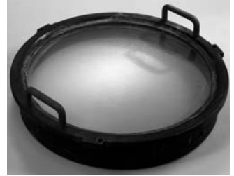
Figure 7.19. L'objectif de 38 cm de diamètre construit par Lerebours père et fils pour l'équatorial de Brunner. L'aspect terne de la surface est dû aux microfissures qui affectent le crown.
