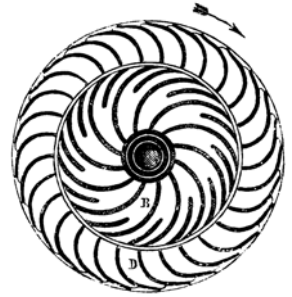
Figure 11.24. Ailettes fixes (B) et mobiles (D) de la turbine de Fourneyron. Explications dans le texte de l'encadré 11.2.
