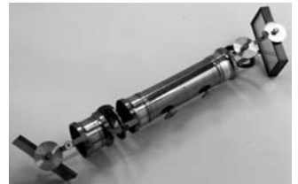
Figure 3.24. Appareil de Biot et Savart (milieu du XIX e siècle). Destiné à l'étude de la polarisation, cet appareil construit par Soleil fils (Henri Soleil, décédé en 1872), est un simple tube qui comporte à une extrémité une glace de verre noir pour polariser la lumière par réflexion, et à l'autre une pile de glaces pour l'analyser ; ces éléments sont orientables dans toutes les directions.
