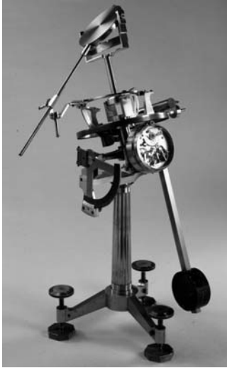
Figure 4.8. Un héliostat de Gambey (1823). Un miroir (en haut, ici recouvert d'un couvercle protecteur), mû par un mécanisme d'horlogerie visible dans la boîte ronde, envoie la lumière du Soleil dans une direction fixe.
