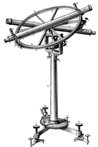
Figure 6.8. Un cercle répétiteur de Borda, construit par Le Noir.
