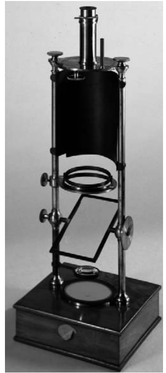
Figure 3.26. Appareil de Nörrenberg, inventé en 1839. L'instrument photographié ici a été construit avant 1849 par Jean-Baptiste François Soleil. Une lumière est réfléchiée vers le bas par la glace rectangulaire sous l'incidence de Brewster, et est donc entièrement polarisée. Après réflexion vers le haut par le miroir horizontal, elle traverse un échantillon placé sur l'anneau médian, puis arrive sur un analyseur de polarisation. Si l'échantillon présente de la polarisation rotatoire chromatique, on observe une couleur avec l'oculaire situé en haut. C'est l'ancêtre du microscope polarisant utilisé en minéralogie.
