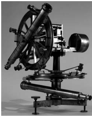
Figure 6.17. Un théodolite répéteur à deux cercles et à deux lunettes construit par Gambey vers 1821. Il aurait servi au rattachement de la France à l'Angleterre en 1821-1823. Des théodolites semblables ont été utilisés pour la triangulation de la France.
