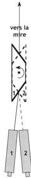
Figure 10.2. Dispositif pour la mesure de l'indice de réfraction des gaz par Biot et Arago, supposé vu du dessus. Explications dans le texte.
