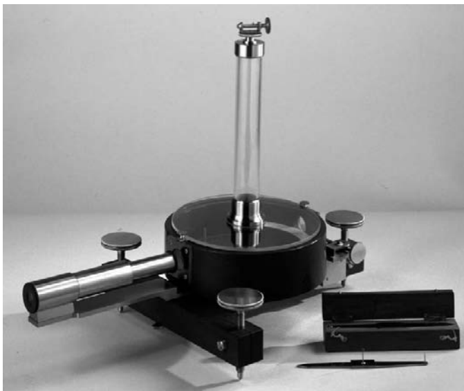
Figure 9.14. Une boussole des intensités. Explications dans le texte. L'appareil, qui appartient à l'Observatoire de Paris et n'est pas signé, est transportable dans une mallette. On voit devant à droite une aiguille aimantée avec sa boîte de transport.
