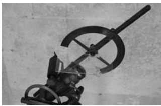
Figure 3.22. Le prototype du polariscope-polarimètre d'Arago (1811). Le constructeur de cet instrument est inconnu. Ici, la pile de lames de verre est remplacée par une simple glace.
