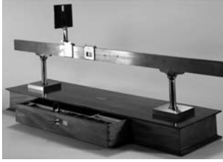
Figure 3.30. Banc d'optique probablement utilisé par Fresnel. Construit par Soleil sans doute vers 1819, en acajou et en laiton, il était destiné à l'étude de la diffraction et des interférences. Le tiroir contient de nombreux accessoires, dont des miroirs de Fresnel.
