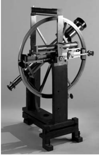
Figure 6.21. Une lunette méridienne portable construite par Johann Brunner vers 1850. Elle comporte un cercle vertical et deux niveaux à bulle.
