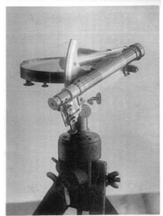
Figure 6.20. Un éclimètre du milieu du XIX e siècle, construit par Georg Oberhaeuser. Cet appareil, destiné à mesurer des hauteurs, est muni d'une lunette et d'un cercle divisé, ainsi que d'une boussole pour le repérage de l'azimut.
