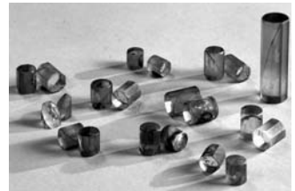
Figure 8.12. Prismes biréfringents pour le micromètre oculaire d'Arago.
