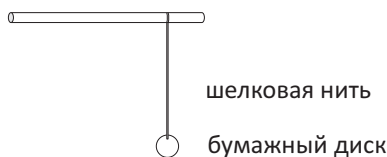
Рис. 4.13: Простой способ приготовления электрического маятника.
